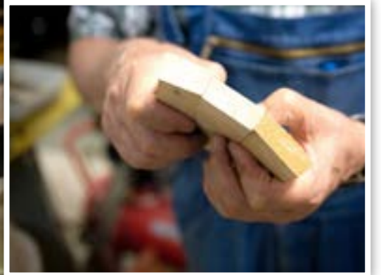
SÄTTER IHOP. Stig Löfholm visar hur stavarna limmas ihop, för att sedan snidas till en perfekt cirkel.
